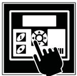
Dans le cas où la douchette et le crayon optique présentent un défaut de lecture, il est possible de saisir manuellement la série de chiffres identifiants ce code à barres dans l'unité de contrôle de la machine (si disponible sur le raccord).
