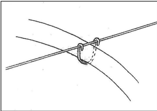
Les fils au faitage (centre de la serre) doivent être espacés de 10 cm puis l'espacement entre fils doit augmenter régulièrement en descendant vers le pied droit.
