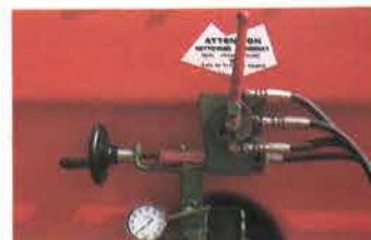
Fig. 3 — COMPTE TOUR RÉGLAGE et EMBRAYAGE
