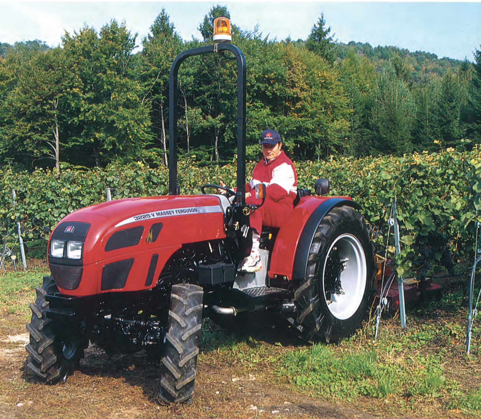
■ Série MF 3200 V spécialisé (type MF 3225 V). Les tracteurs 3200 Vignerons étaient légèrement plus longs et moins hauts que les autres modèles spécialisés. On remarquera les ouïes d'aération différentes de celles des autres types 3200 spécialisés.
