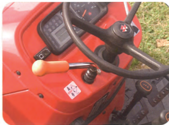
■ Série MF 400. Vue des leviers de changement de gammes et de vitesses, au plancher (photo de gauche), et de l'inverseur mécanique à gauche du volant (photo de droite).
