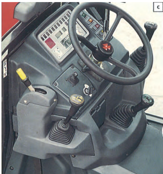
■ Série MF 3200 spécialisé. Détails de la planche de bord et des leviers de transmission.
