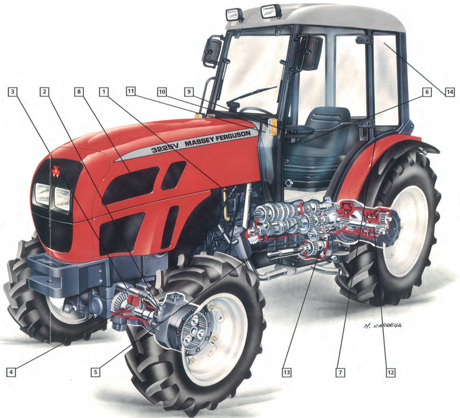
■ Série MF 3200 spécialisé (type MF 3225 V). Vue d'ensemble schématique de la transmission.
