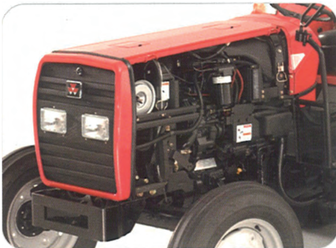
■ Série MF 400. Excellente accessibilité mécanique après retrait des tôles latérales de capot.
