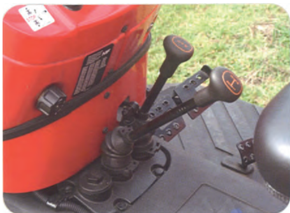
■ Série MF 400. Vue des leviers de changement de gammes et de vitesses, au plancher (photo de gauche), et de l'inverseur mécanique à gauche du volant (photo de droite).
