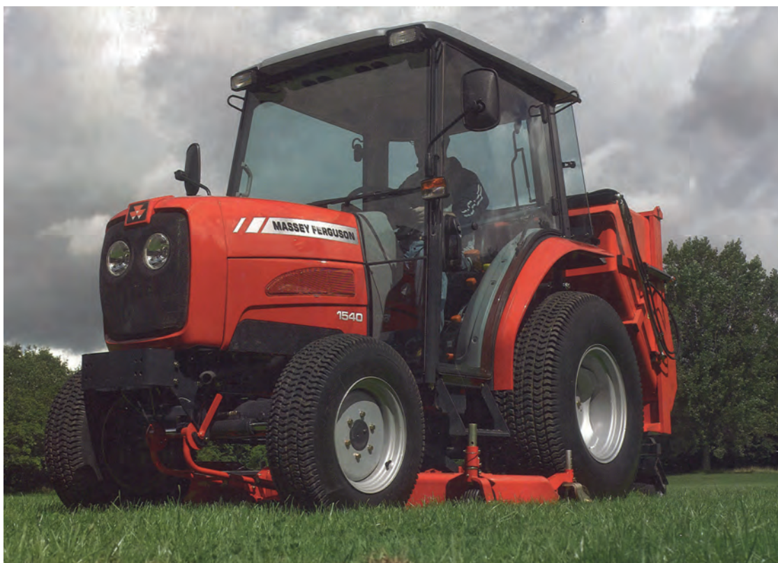
■ Série MF 1500 (type MF 1540) de haut de gamme pour entretien de jardin, équipée d'une cabine et d'une tondeuse ventrale, toutes deux en options. Seuls les MF 1540 et 1547 pouvaient recevoir la cabine.
