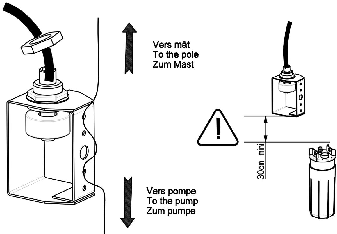
**17** **Lier les câbles de la pompe (tuyau souple + câble électrique)**
