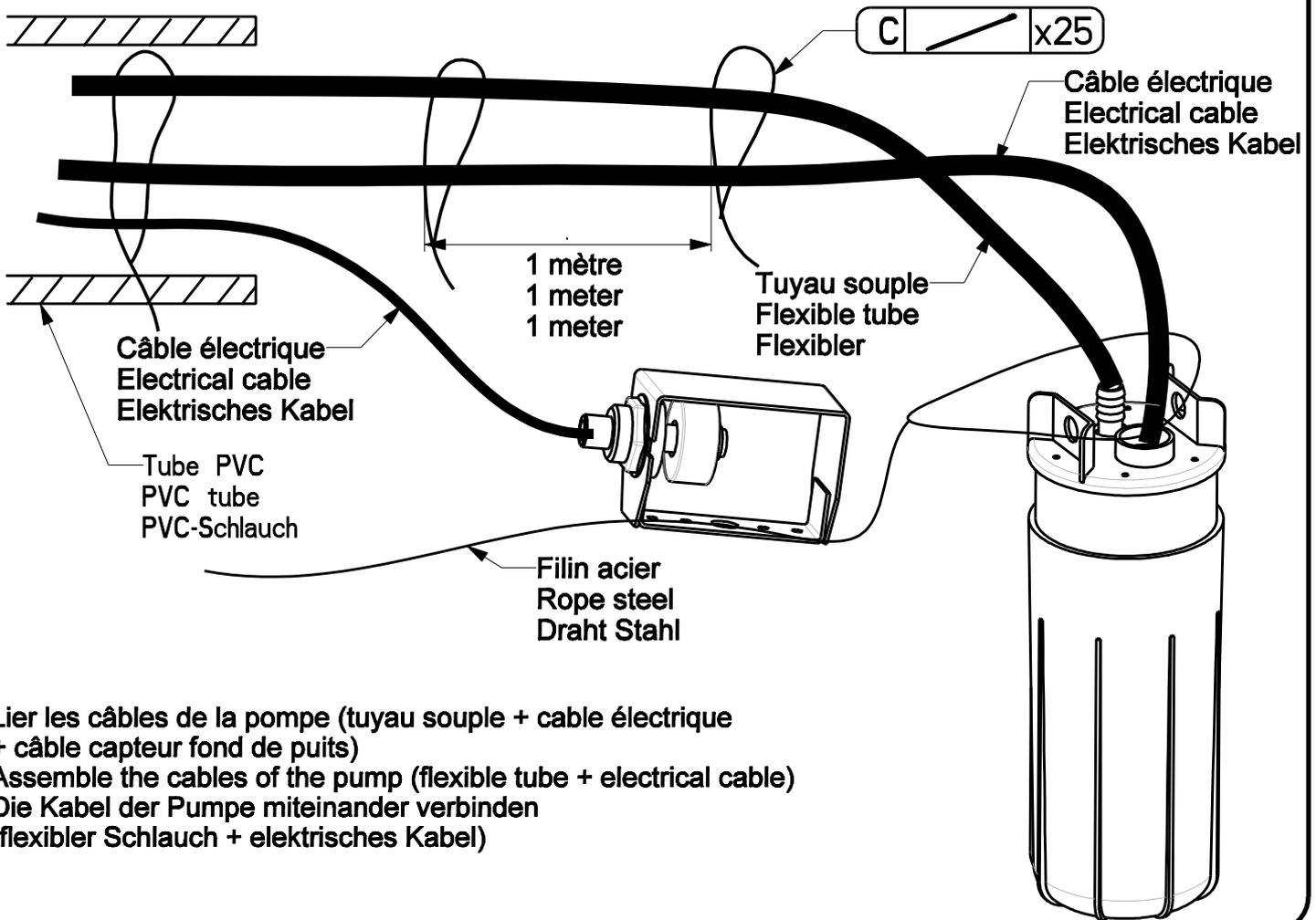
Lier les câbles de la pompe (tuyau souple + câble électrique + câble capteur fond de puits)
