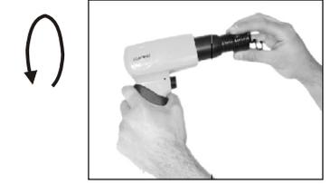
Le ressort se retire en le dévissant dans le sens contraire, prendre appui sur la boucle finale.
