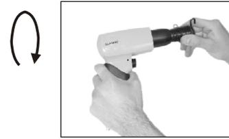
Le ressort se visse sur le cylindre dans le sens des aiguilles d'une montre.
