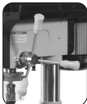
Cabestan pour droitier Boeganker voor rechtshandig Cabrestante para derecha Cabrestante para destro Argano per mano destra Capstan for right handed
