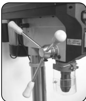
Cabestan pour gaucher Boeganker voor Lefty Cabrestante para zurdo Cabrestante para Lefty Argano per Lefty Left hand capstan
